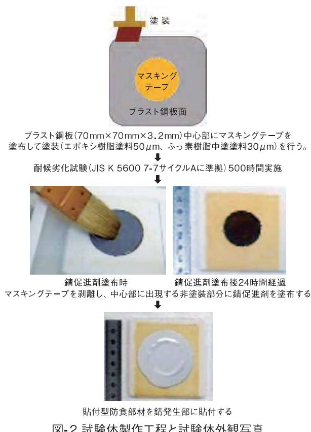
図-2 試験体製作工程と試験体外観写真
