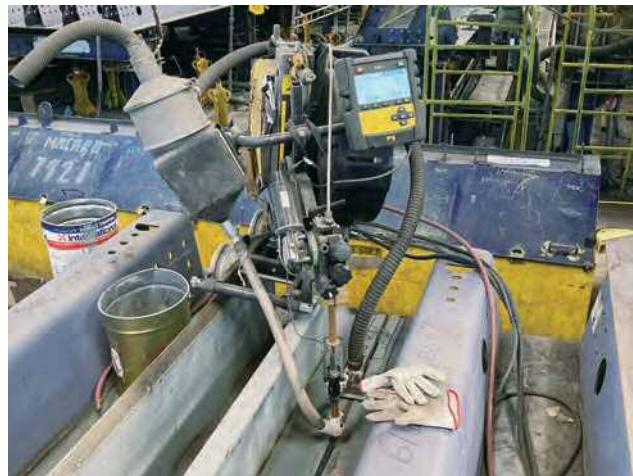
写真-8 サブマージアーク溶接によるパネル板縫接状況
