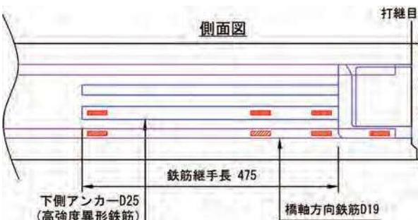
図-8 試験体配筋図および載荷位置
