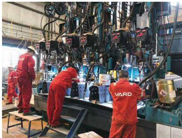
写真-4 6電極サブマージアーク溶接機
