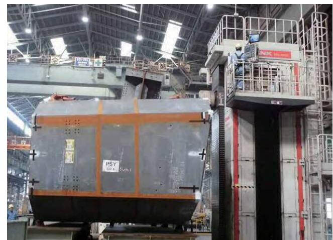
写真-2 端面切削状況
