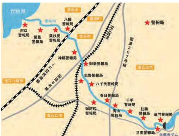
図-2 放流警報設備配置図
