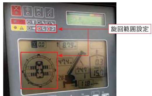
写真-1 クレーン操縦パネル
