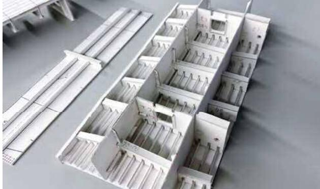
写真-3 製作中の模型(鋼床版箱桁)
