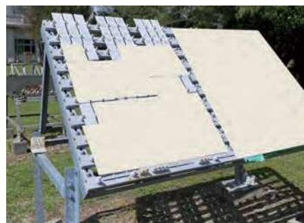
写真-6 温暖塩害地域 試験体設置後外観写真
