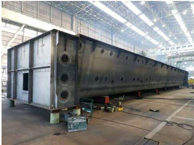
写真-3 水平状態での仮組立状況
