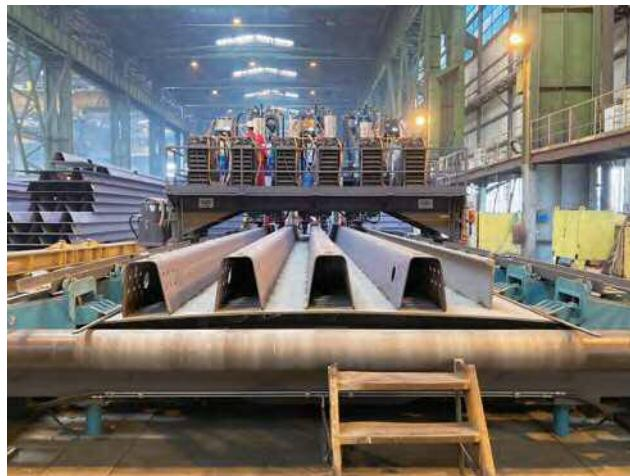
写真-5 逆歪による溶接変形対策
