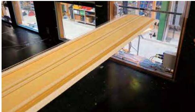
写真-1 補剛桁2次元模型(1 / 75)
