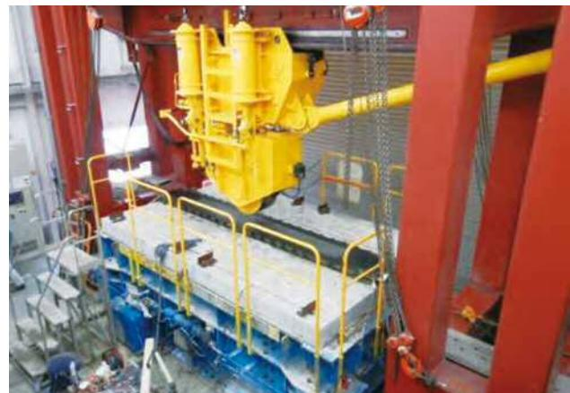
写真-6 輪荷重走行試験機
