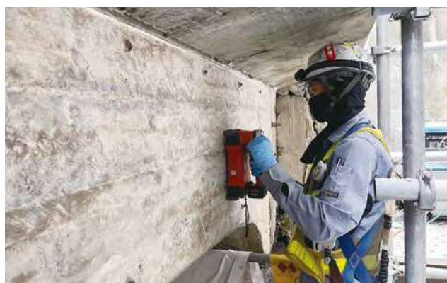
写真-2 主桁下縁部鉄筋探査状況
