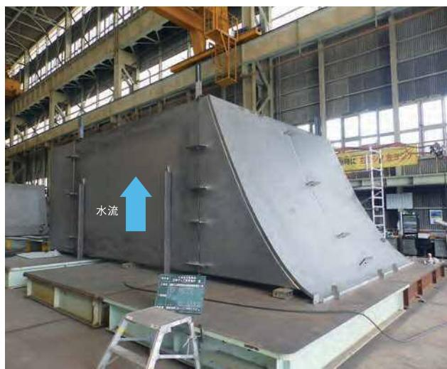
写真-2 下段放流管 上流側ブロック
