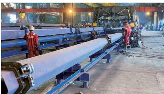
写真-2 トラフ溶接治具
